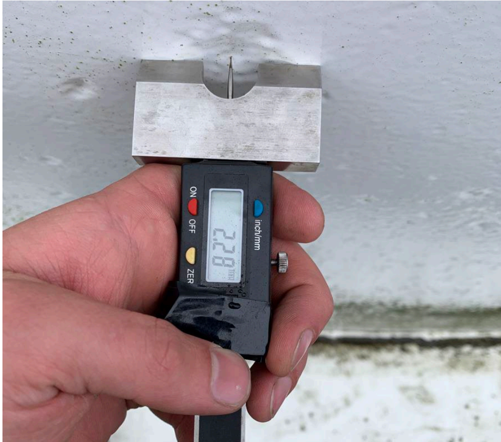
Mynd 9. Víða má finna rúmlega 2mm djúpa pytti utanvert.
