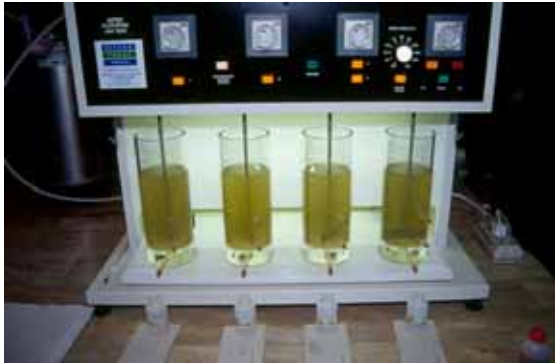
Figur 5.3 Forsøksapparat for forundersøkelser av flotasjon
